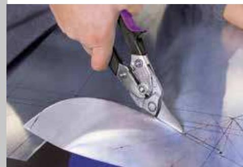
\* As tesouras podem ser utilizadas em espessuras até 3 x 0,6 mm (1,8 mm) por curtos períodos para corte de juntas.
