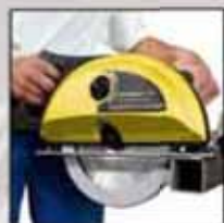
Com uma profundidade de corte até 82 mm
