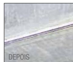
**ES** Innovadores sistemas para la limpieza de las partes soldadas en TIG y MIG en acero inoxidable. Gracias a una reacción electroquímica instantánea, devuelven el brillo al acero inoxidable y eliminan rápidamente los efectos de coloración y oxidación que se forman durante el proceso de soldadura.
