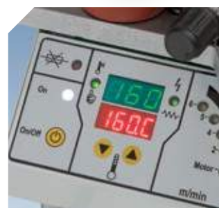
Regulação da temperatura (120 a 200°C) controlada por microprocessador para maior precisão. Sistema de controle da temperatura por impulsos. Protege as resistências e aumenta a duração
