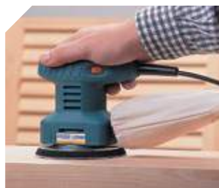
Como rotorbital combina movimento orbital e vibratório.
