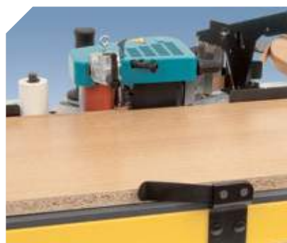
Guia extensível com prensor para maior apoio da placa a orlar.
