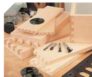
4 tipos de malhetes diferentes. Acabamento perfeito do malhete.
