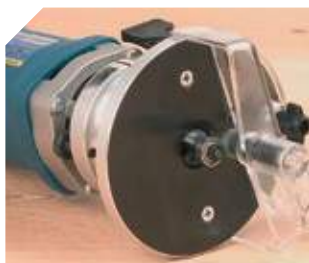
Sistema de travão do rolamento para evitar estragar o painel aquando do início do trabalho.
