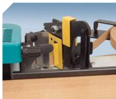
Corte trasero del canto automático. Incluye pedal para piezas redondas o con formas
