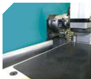
Esquadro e apoio do painel com precisão.
