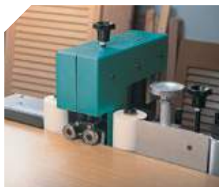
Perfilador motorizado em ambas as faces simultaneamente.
