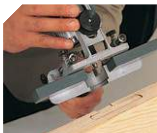
Colocação de dobradiças com o cabeçal ZB93.
