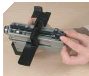
Ajuste micrométrico da largura de corte.
