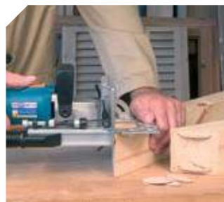
Uniões fortes com lamelas No. 6.
