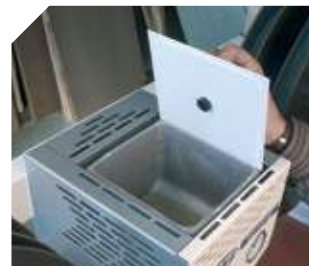
Depósito de cola de fácil acesso. Sistema de cola com rolo de silicone antiaderente de limpeza fácil.
