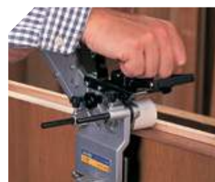
Orlando a face interior de porta com rebaiço
