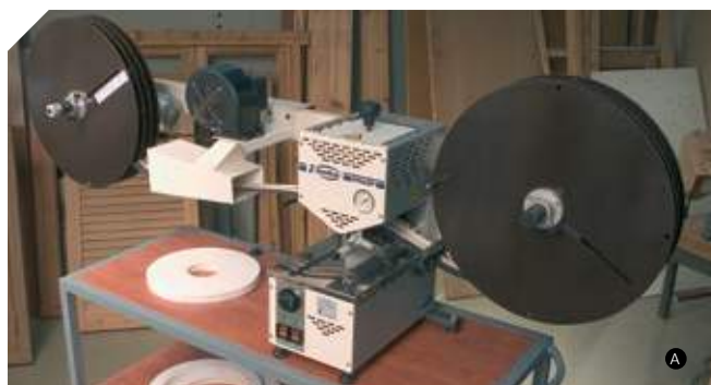
Depósito de cola de fácil acesso. Sistema de cola com rolo de silicone antiaderente de limpeza fácil.
