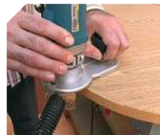
O cabeçal CA56U permite perfilar as 4 faces do painel ao mesmo tempo. A grande base de apoio e a pega adicional resultam numa grande estabilidade.
