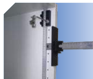
Furação para colocação de dobradiças invisíveis.
