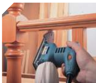
Uso da base delta em superfícies difíceis.
