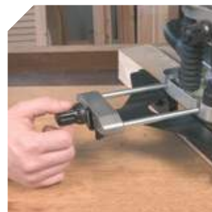
Esquadro lateral com ajuste micrométrico e guias ajustáveis.
