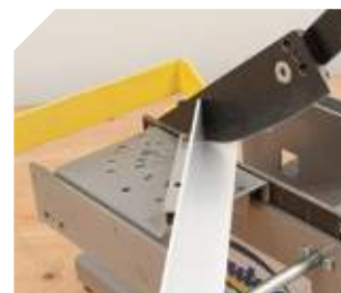
Extremidade da navalha biselada para o corte à medida de calhas em PVC.
