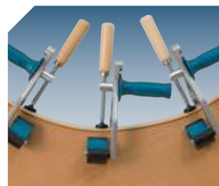
Fixação de cantos em painéis côncavos
