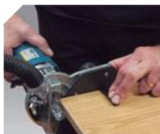
Ligação de aspiração dotada dum freio para o rolamento que evita estragar o canto
