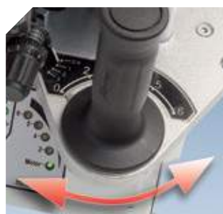
Regulação electrónica da velocidade de avanço controlada por microprocessador.
