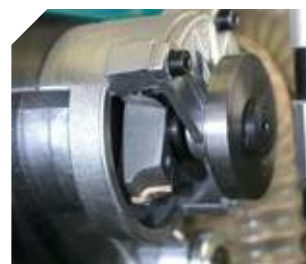
Copiador hidráulico independente da fresa.
