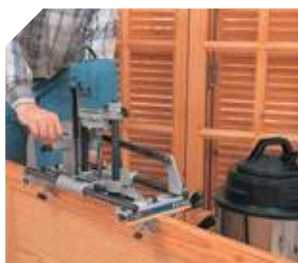
A máquina pode trabalhar horizontalmente. Especialmente útil se decidir fazer múltiplos rasgos em portas não aplicadas.
