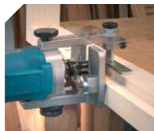
Realização de rebaixo com fresa de opção ref. 1240046 (e esquadros ref. 1250041 ou 1850042)
