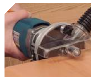
Cabeçal redondo V3 incluído na equipamento. Muito prático para perfilar com apoio sobre o canto para os trabalhos que o requerem assim.
